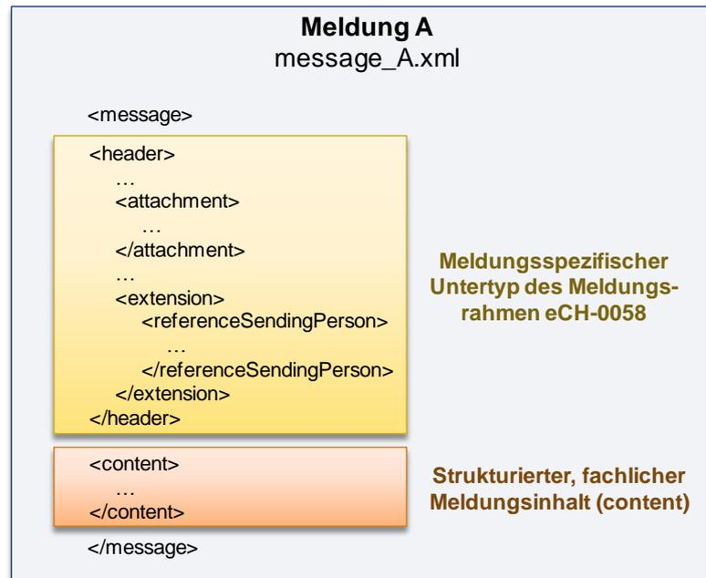
Abbildung 6: Aufbau einer message\_A.xml innerhalb eines sedex-Nutzdatenpakets.
